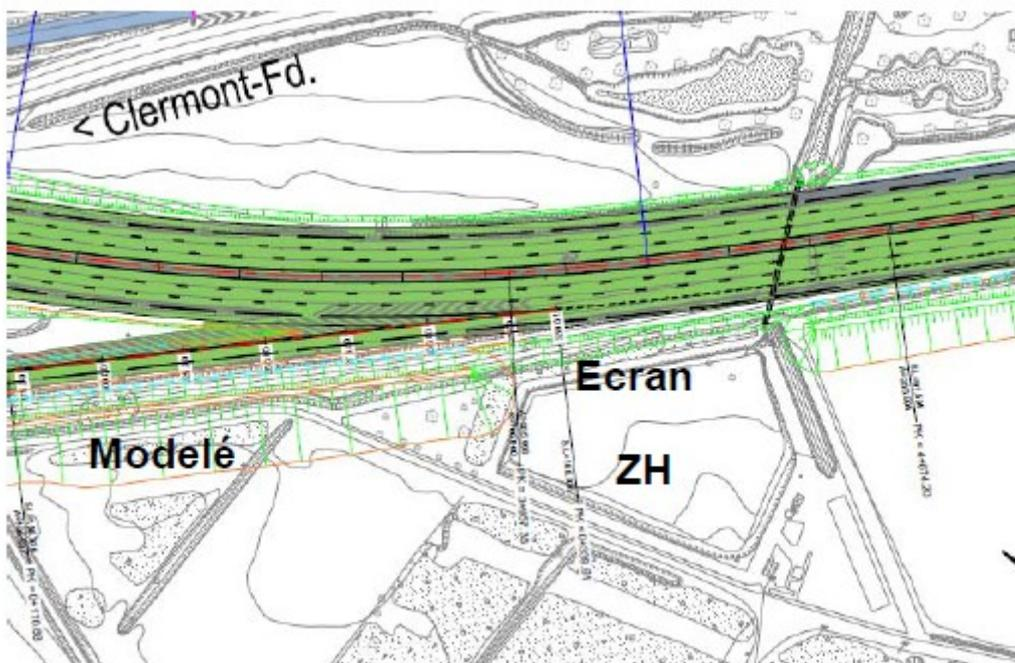
**Figure 1 : Évitement de la zone humide par mise en place d'un écran en lieu et place du modelé (Source : Egis)**
