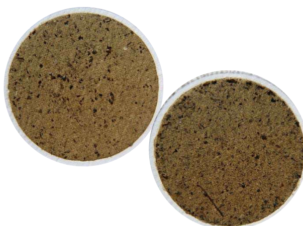
Récupération des poussières insolubles sur filtre
