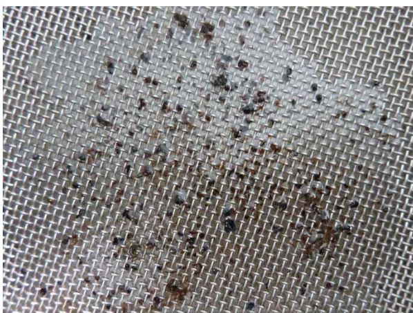
Vue des particules grossières récupérées sur tamis
