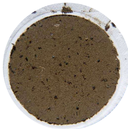
Récupération des poussières insolubles sur filtre
