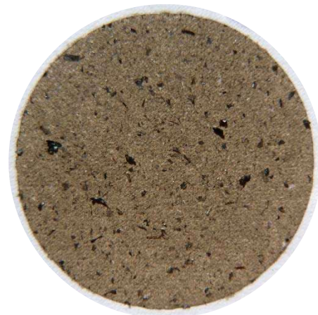
Récupération des poussières insolubles sur filtre
