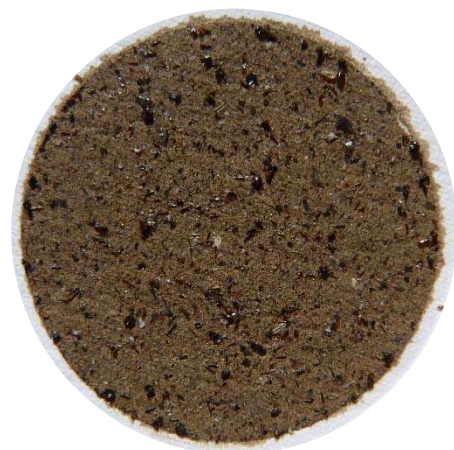
Récupération des poussières insolubles sur filtre
