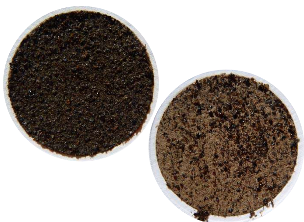
Récupération des poussières insolubles sur filtre
