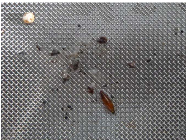
Vue des particules grossières récupérées sur tamis
