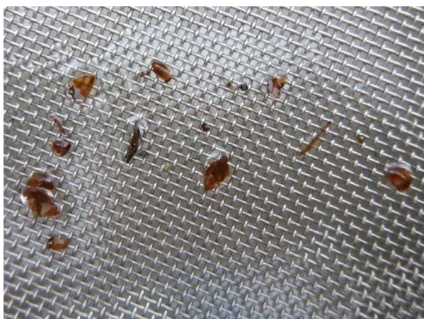
Vue des particules grossières récupérées sur tamis
