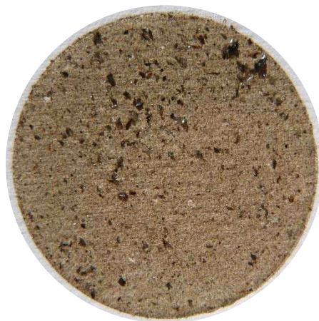
Récupération des poussières insolubles sur filtre
