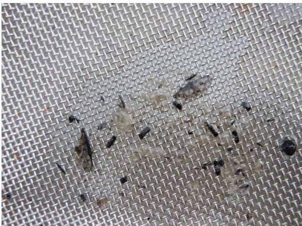
Vue des particules grossières récupérées sur tamis
